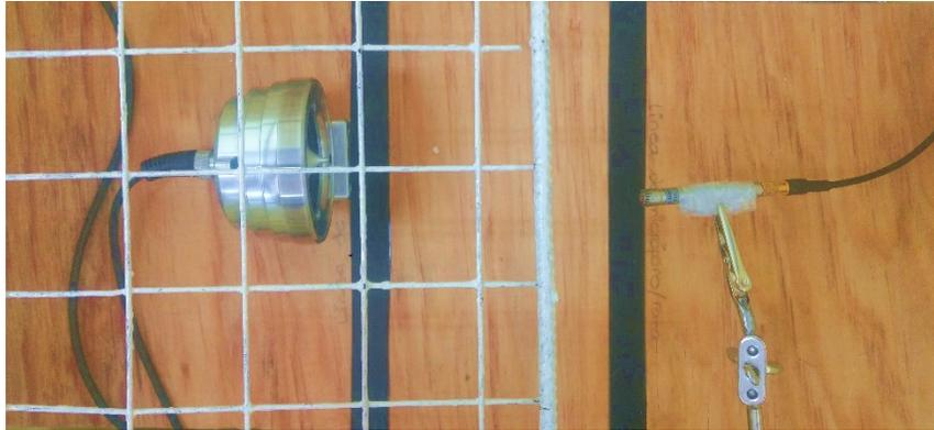
*Figura 13. Calibración de la bocina (izquierda) con ayuda del micrófono Gras (derecha).*
