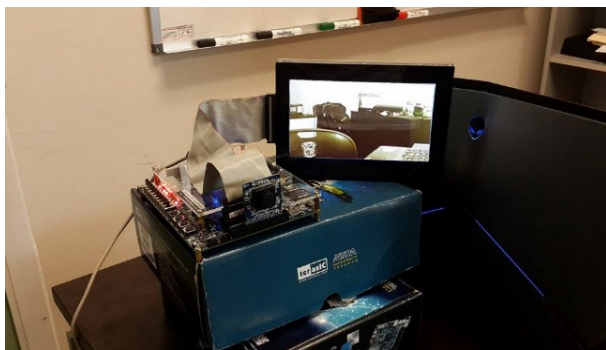
IMAGEN 6: Sensor Óptico LI-5M03 y pantalla LCD en funcionamiento, capturando una escena.
