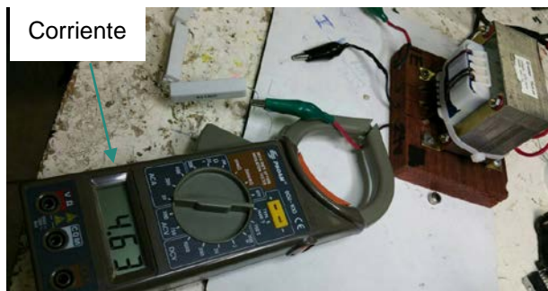
IMAGEN 9: Medición de corriente.
