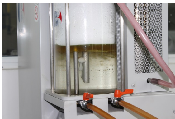
Figura 1.- Equipo experimental para la obtención de combustible mediante la pirólisis de desechos plásticos.
