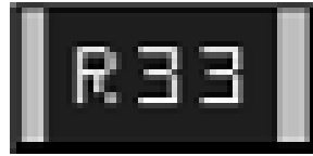
Figura 2.2: Resistencia SMD con valor de 0.33 \Omega .
