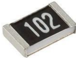
Figura 2.1: Resistencia SMD con valor de 1\text{K}\Omega .
