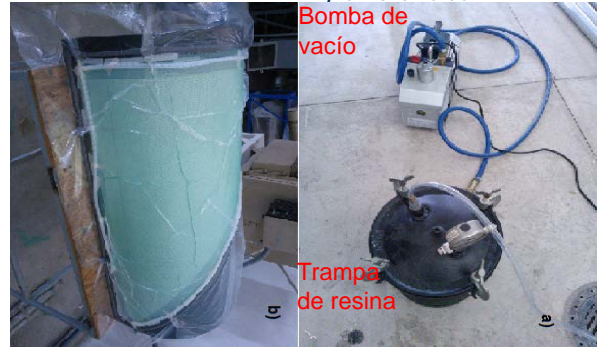
figura 7: Colocación de la tela filtrante y la malla verde.
