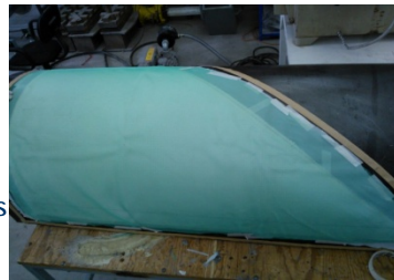
figura 10: a) Equipo preparado para el inicio de la infusión, b) Comprobación de vacío.
