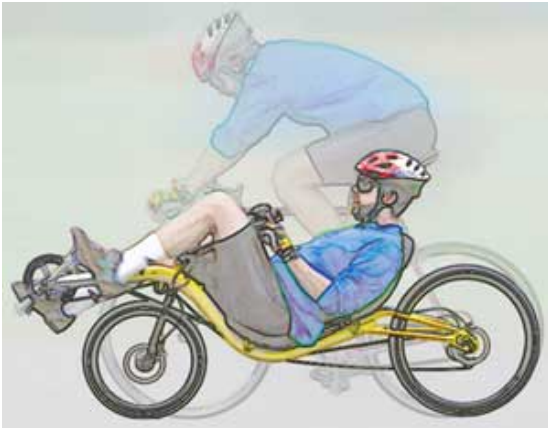
FIG. 1.1: Diferencia de posiciones entre una bicicleta normal y una recumbente.
