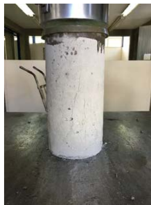
Figura 6. Prueba de resistencia al cilindro.
