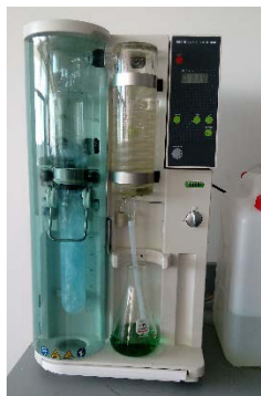
IMAGEN 7. Destilación de la muestra para la determinación de proteína.
