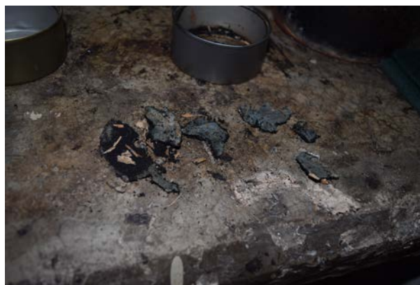
IMAGEN 3: La mezcla obtenida de las diferentes proporciones daba como resultado una mezcla quebradiza, debido a la diferencia de temperaturas de fundición del plástico y PET.
