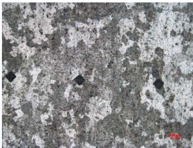
IMAGEN 1: Ensayo de dureza, pieza de Aluminio 6061-T6 original.
