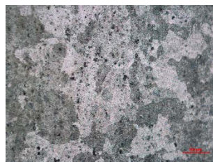
IMAGEN 2: Microestructura de la pieza de Aluminio 6061 a 500 psi, cara longitudinal.
