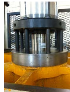
IMAGEN 11: Colocación de la celda de carga.
