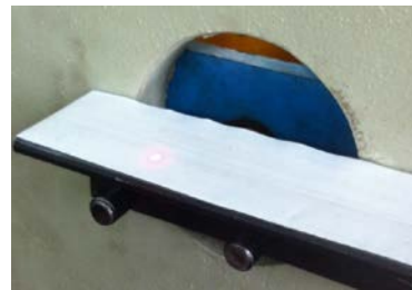
IMAGEN 5: Montaje de la placa reflejante en la parte móvil de la prensa.
