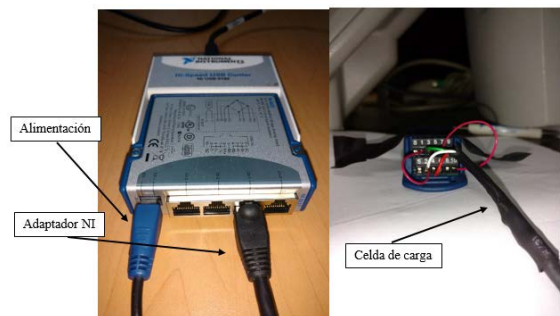
IMAGEN 12: Conexiones con el puente de Wheatstone y el adaptador NI.
