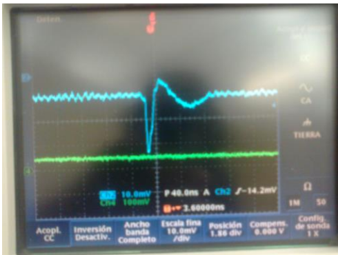
Figura 12. Pulso en el Canal B1 a 1100 V.
