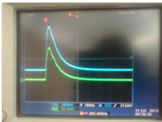
Figura 8. Señales obtenidas en Vout (Azul) y Vout2 (Verde) con pulsos de 1 Vpp y frecuencia de 100 kHz.
