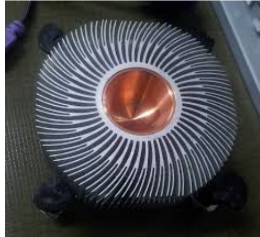
IMAGEN 1: Disipador de calor radial convencionalmente usado en computadoras y el cual usa aire como fluido de disipación.
