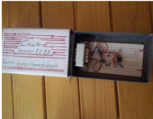
Imagen 8: Circuito inversor armado
