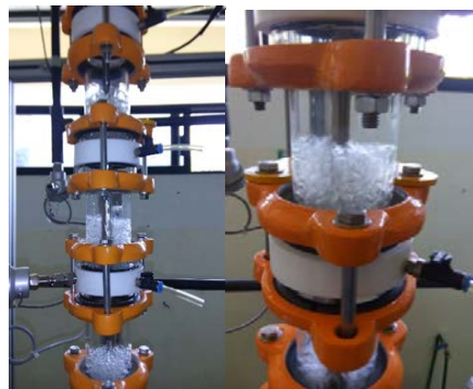
IMAGEN 1: Funcionamiento normal de la columna de destilación
