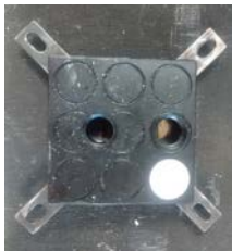
IMAGEN 2: Disipador de calor comercial Cool Master.
