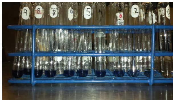
IMAGEN 2: Muestras de medio NBRIP líquido con reactivo mixto, para determinación de fósforo
