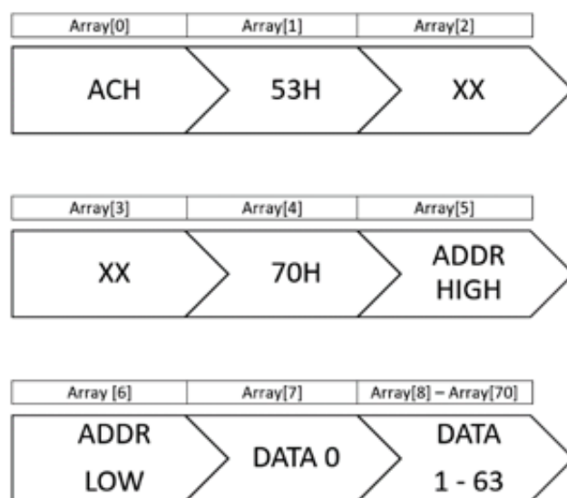
Figura 6- Secuencia de datos que se envían al microcontrolador para poder realizar la escritura de una subpágina de código.
