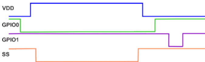
Figura 3- Formas de onda de las señales de control para acceder, programar y salir del modo ISP.
