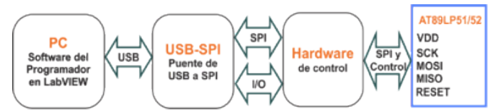
Figura 1- Diagrama a bloques del programador.
