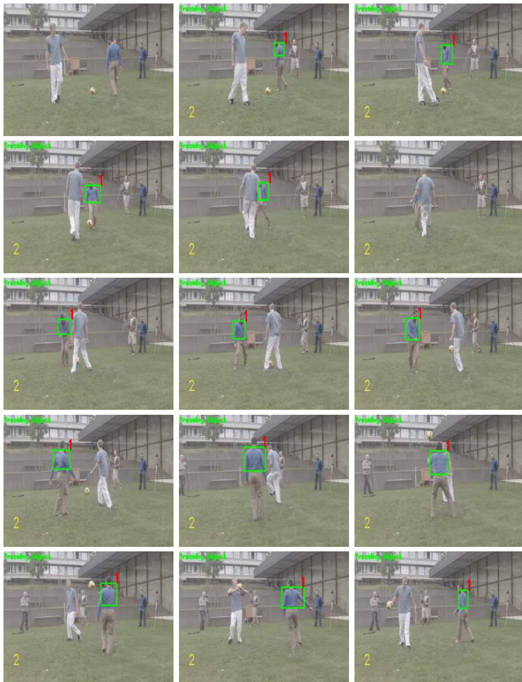
Figura B.2: Seguimiento visual de un suéter azul en un ambiente no controlado visto desde la cámara 2 en el vídeo dos.
