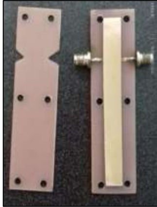
Figura 4.4. Muestra del sustrato RO 6010 en el dispositivo de medición.
