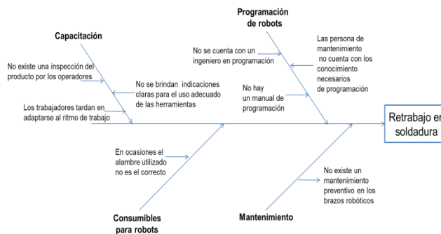
Figura 1. Diagrama de Ishikawa para el análisis de los reprocesos en soldadura
