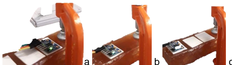
Imagen 3: Posición del sensor en pruebas de vibración, 3a posterior, 3b central, 3c extremo.
