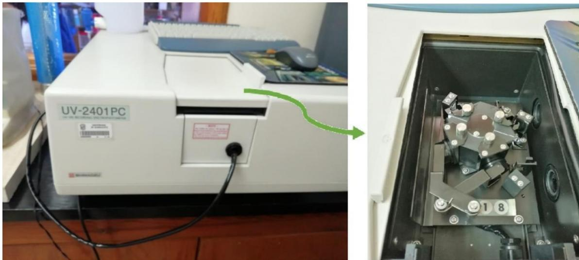
**Figura 45.** Shimadzu modelo UV-2401 PC, equipo de espectroscopia UV-VIS de reflectancia difusa.
