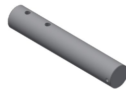
IMAGEN 12. Propuesta 1 de rediseño en zona de eje de giro.
