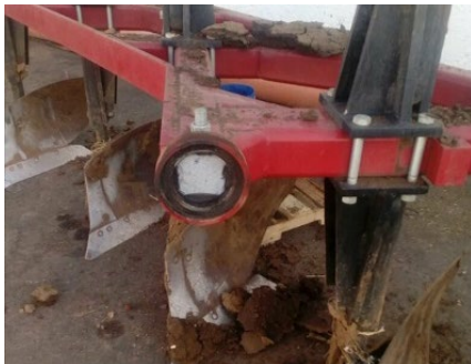
IMAGEN 1. Falla del eje de giro del arado de vertederas.
