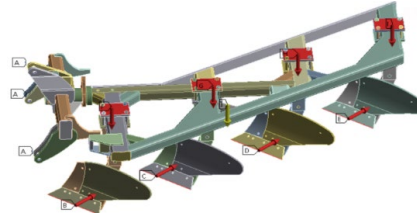
IMAGEN 5. Condiciones de frontera para Arado de Vertedera.
