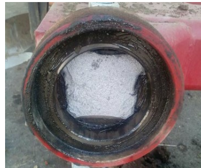
IMAGEN 1. Falla del eje de giro del arado de vertederas.
