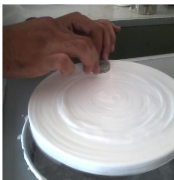
IMAGEN 4 Proceso de pulido con abrasivo de 0.5 \mu m
