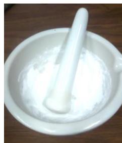
IMAGEN 1 Proceso de molienda con mortero y pistilo
