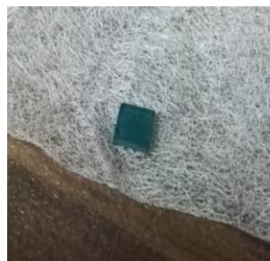
IMAGEN 5 Muestra \text{Li}_2\text{B}_4\text{O}_7:\text{Yb} 0.5% y \text{Cu} 0.8% de medidas de 3x3x1mm.
