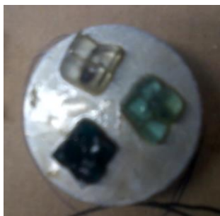
IMAGEN 3 Parte de las muestras una vez cortadas, preparadas para esmerilar para reducir su tamaño.
