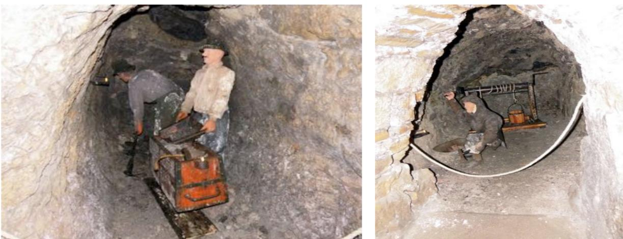
Imagen 113. Excavación a mano para extraer el mineral.
