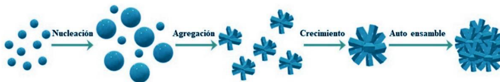
Figura 8. Mecanismo de formación de estructuras jerárquicas mediante método solvotermal.
