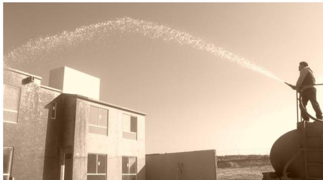
Fig.72. Pruebas de escurrimiento en losas (Topacio)
