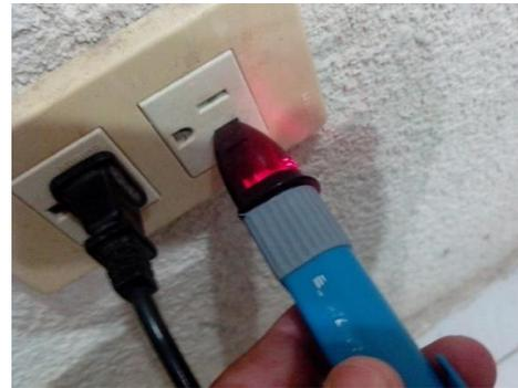
Fig. 38. Aparato usado en la medición del Voltaje. Fig. 39. Aparato usado para medir la correcta Polaridad en el cableados de la vivienda
