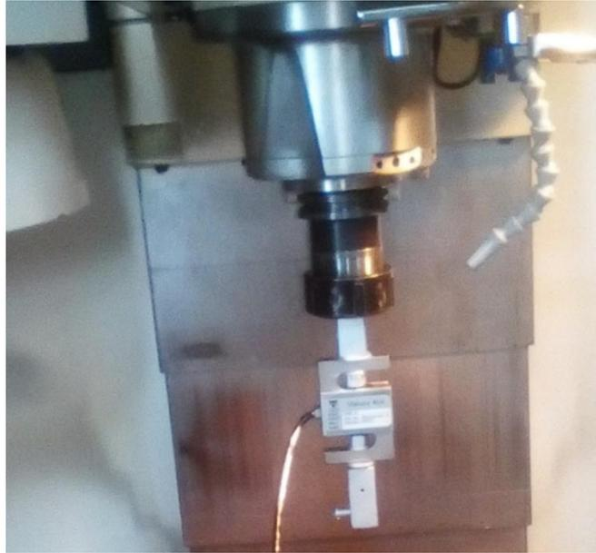
Figura 3.6 Bruñidor y celda de carga colocados para la linealización.
