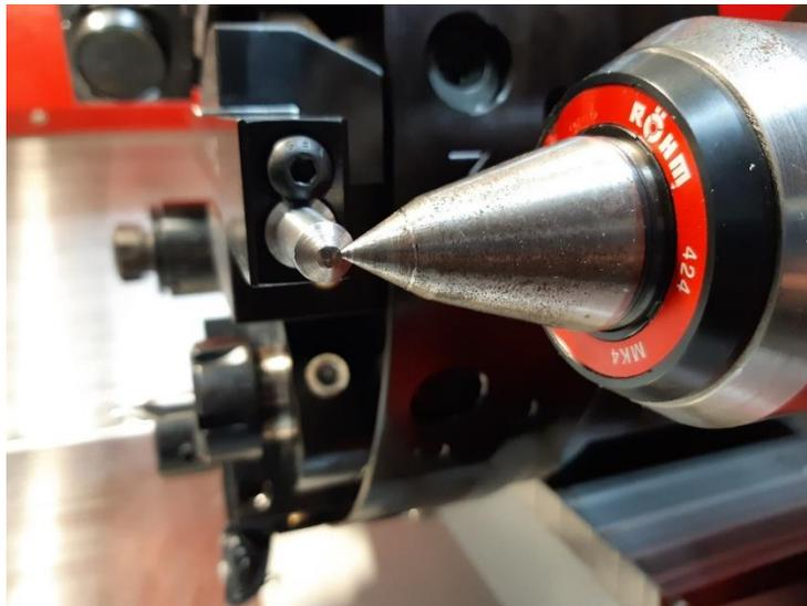
Figura 3.5 Centrado del bruñidor con bola.
