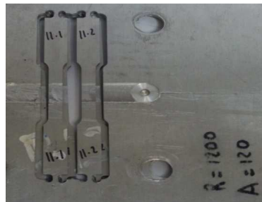
Figura 4.14. Corte de las probetas para pruebas de tensión del segundo diseño de experimentos.
