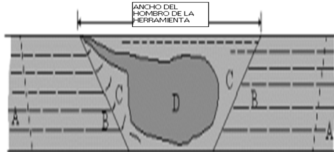
Figura 2.2. Regiones microestructurales en la sección transversal de un material soldado por fricción. (A) material no afectado o metal base. (B) Zona afectada por el calor. (C) Zona afectada termomecánicamente. (D) Zona núcleo [3].
