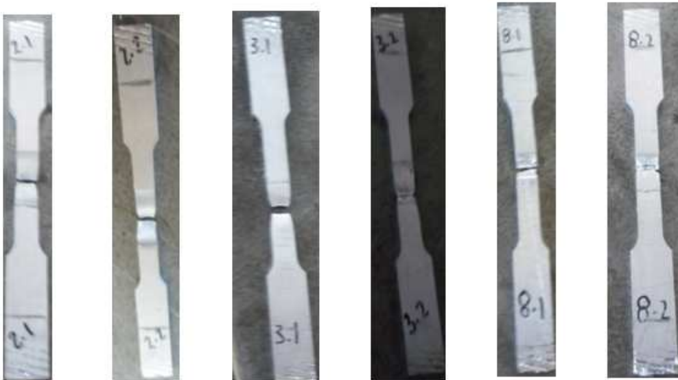
Figura 4.18. Prueba de 2 mm/s – 960 rpm, fuerza máxima = 187.5 Kgf.
