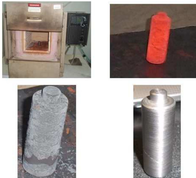
Figura 4.1. Proceso de temple de las herramientas.
