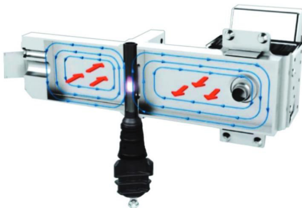
Figura 27. Esquema que presenta el efecto de envoltura del campo magnético que da forma al plasma [95].
