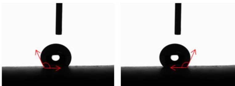
Figura 147. Representación de medición de ángulo de contacto estático por ambos lados de la gota.
