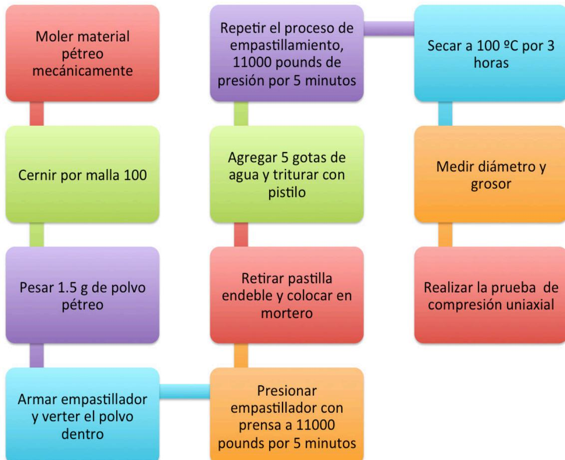
Figura 159. Proceso para realizar pastillas de material pétreo en polvo.
