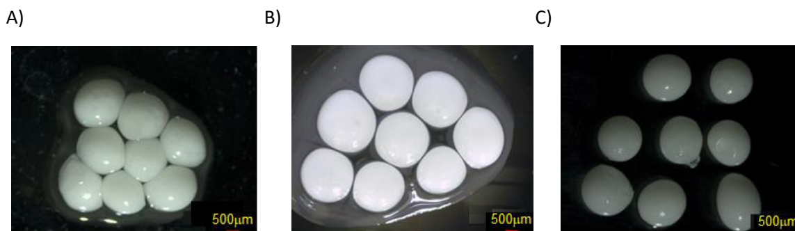
Figura 27. Microcápsulas en HCl 0.1 M, fabricadas en diferentes concentraciones de alginato de sodio: a) 1% (1.00 mm), b) 0.5 % (1.00 mm) y c) 0.2% (1.00 mm).
