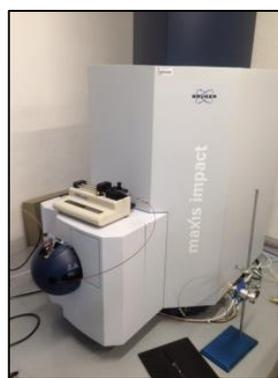
**Figura 17.** Ilustración del sistema FIA-ESI-QTOF-MS montado en el laboratorio, con válvula de inyección Rheodyne y flujo del portador controlado por la bomba de carga de sistema HPLC.
