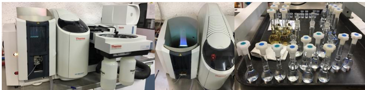
Figura 13. Cuantificación de As en el equipo iCE 3000 Espectrómetro de Absorción Atómica.
