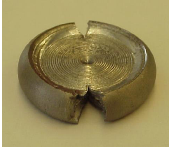
Figura 1.19.- Probeta con espiral después de la deformación [21]
