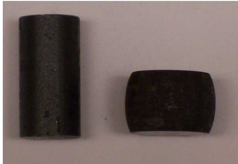
Figura 1.15.- Probeta antes y después de la compresión [19]
