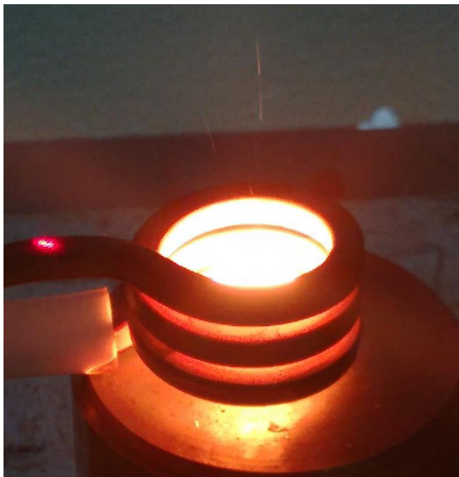
Figura 5.10.- Decarburización de la probeta
