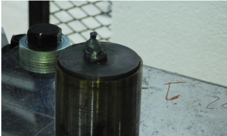
Figura 5.9.- Probeta fundida por sobre-exposición al inductor
