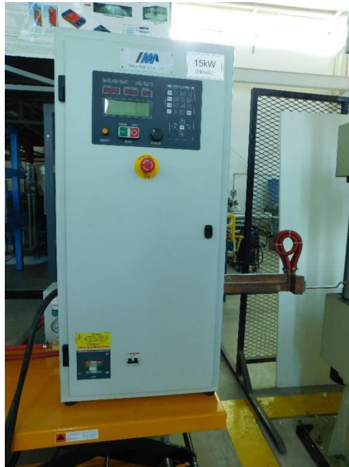
Figura 5.3.- Sistema de control de potencia
