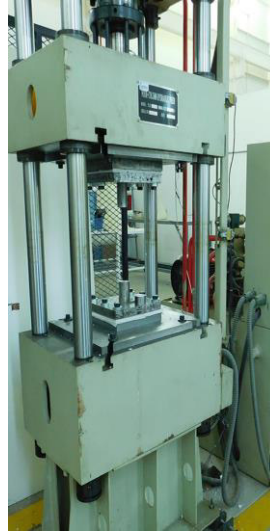
Figura 5.1.- Instalación de la parte mecánica del plastómetro
