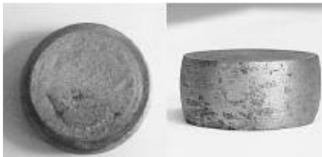
Figura 1.13.- Probeta sometida a prueba de compresión con abarrilamiento [14]
