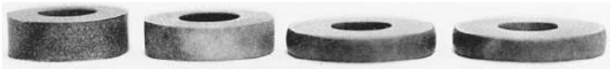
Figura 1.25.- Ejemplos de los anillos con varias reducciones de altura [2]
