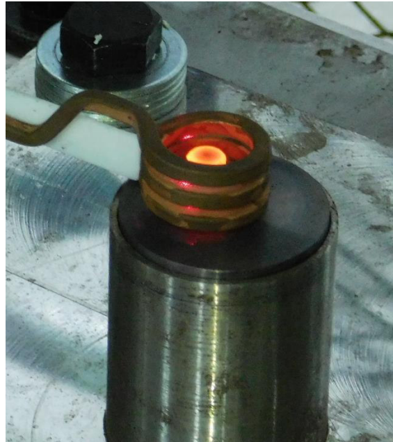
Figura 5.7.- Calentamiento de la parte externa hacia la parte interna de la probeta
