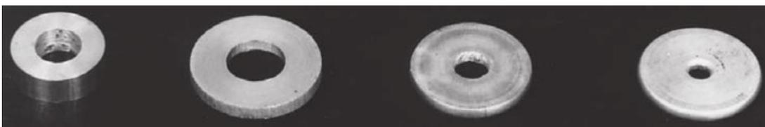
Figura 1.21. Anillos obtenidos por Male&Cockcroft; sin deformar, deformado a baja fricción, a media fricción y a alta fricción (de izquierda a derecha) [24].
