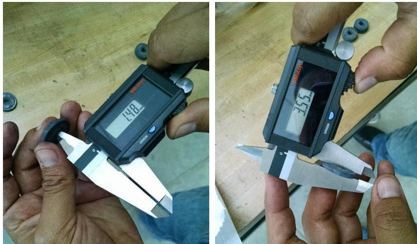
*Figura 4.3. Medición de altura y diámetro interno de anillo con Vernier Digital Mitutoyo®.*
