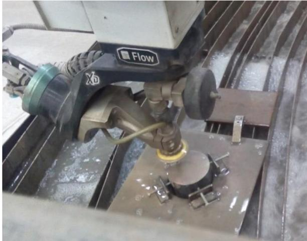
*Figura 2.24. Montaje de redondo de acero especial en cortadora por chorro de agua abrasiva marca Dynamic Waterjet.*
