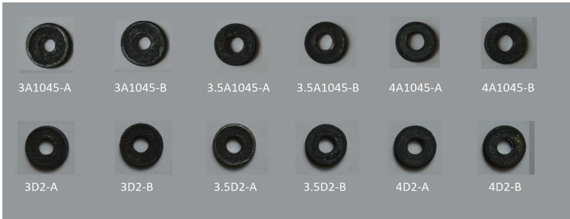
*Figura 4.2. Anillos después de la prueba de compresión experimental.*
