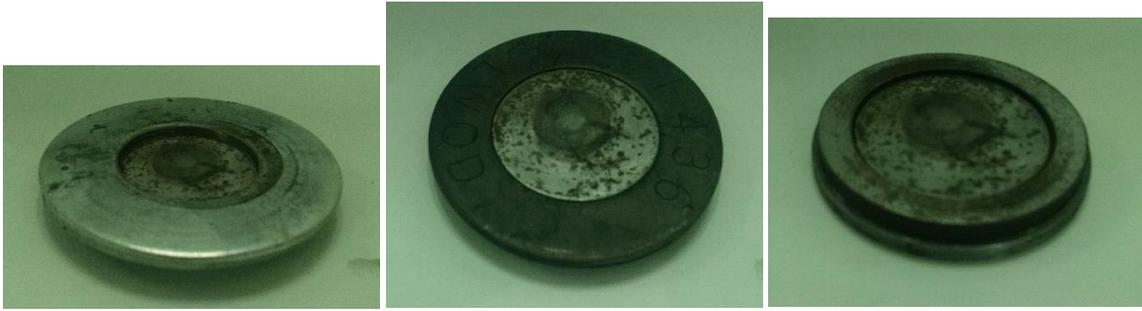
*Figura 2.22. Ensamble de dado inferior con las tres distintas rondanas que actuarán como topes.*
