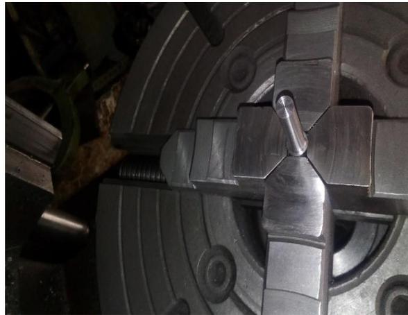
*Figura 2.27. Careado de tocho cilíndrico en torno mecánico convencional.*
