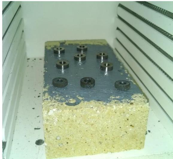
*Figura 2.36. Tabique refractario untado con pasta lubricante [los datos específicos son confidenciales y se encuentran en reportes a la empresa y en las tesis de los sinodales] dentro del horno.*
