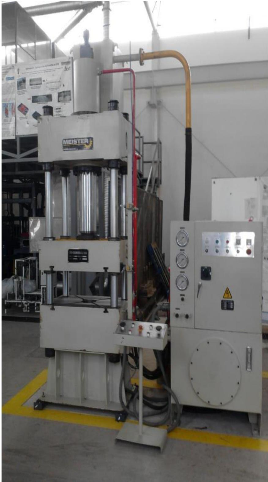
*Figura 2.6. Prensa hidráulica YL32-100 ubicada en DICIS – UG.*
