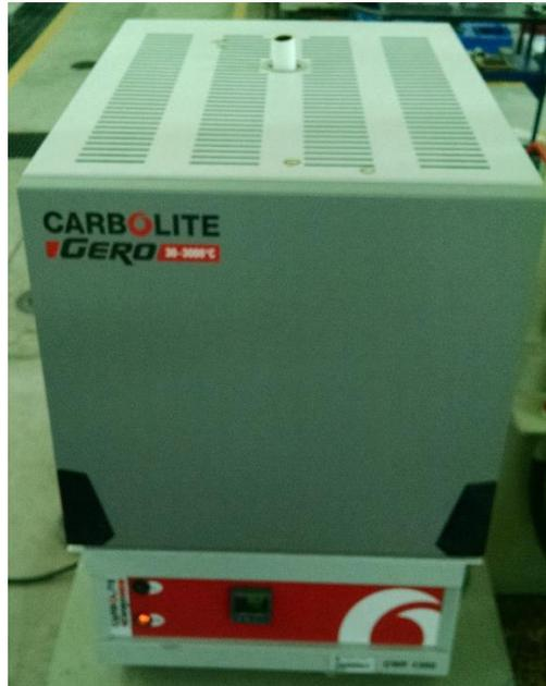
*Figura 2.35. Horno Carbolite Gero 3000® para calentar los anillos.*
