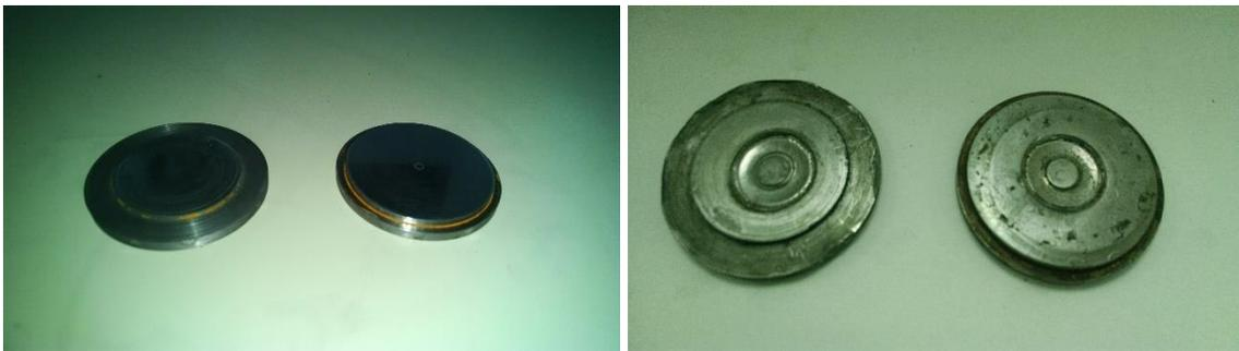
*Figura 4.1. Imagen de dados de Acero AISI-SAE 1045 dañados al final de las pruebas de compresión de anillo.*
