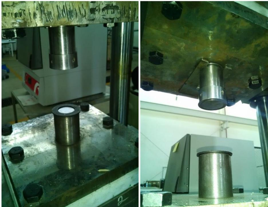
*Figura 2.34. Montaje de herramientas tope en prensa.*
