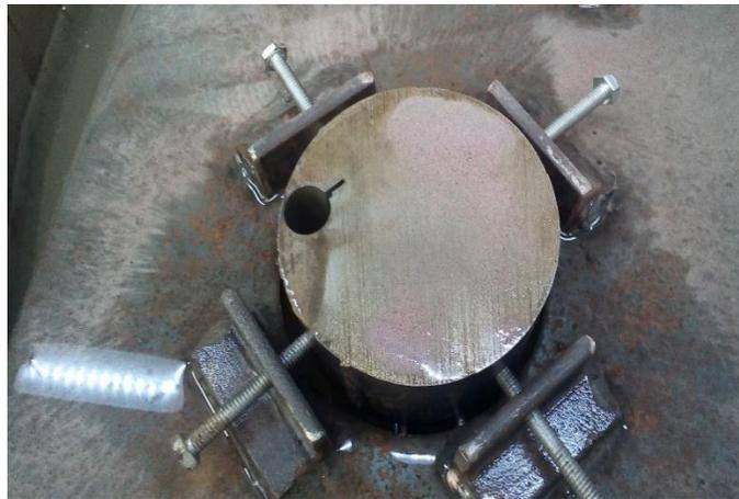
*Figura 2.25. Primera pieza cortada con chorro de agua abrasiva marca Dynamic Waterjet.*
