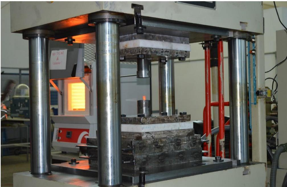
Figura 2.17. Fotografía herramental construido en la primera etapa del proyecto efectuando una prueba de compresión de probeta cilíndrica a altas temperaturas.
