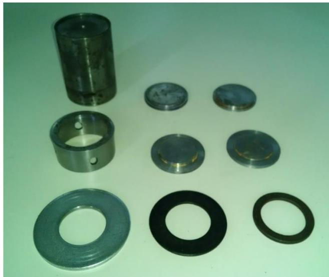
*Figura 2.21. Herramientales fabricados para actuar como tope, para la prueba de compresión de anillo a altas temperaturas.*
