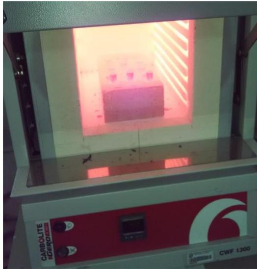
Figura 2.37. Horno con anillos calentados a 1300°C.
