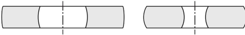
Figura 1.22. Esquema de factor de fricción bajo (imagen izquierda) y esquema de factor de fricción alto (imagen derecha) [7].
