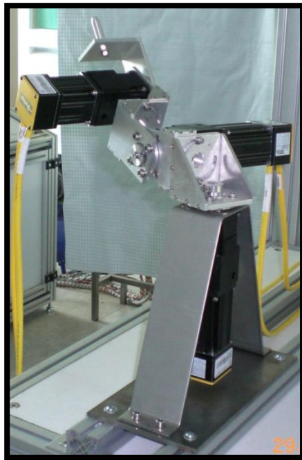
Figura 5.20 Prototipo experimental 3R. a) Arquitectura ortogonal [\alpha_1 = -90^\circ, \alpha_2 = 180^\circ] , b) Arquitectura arbitraria [\alpha_1 = -120^\circ, \alpha_2 = 210^\circ] .
