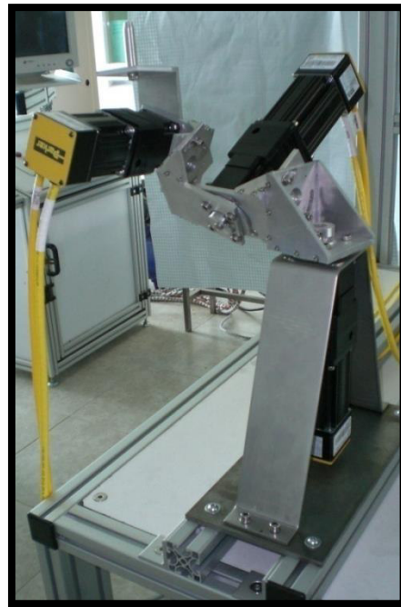
Figura 5.20 Prototipo experimental 3R. a) Arquitectura ortogonal [\alpha_1 = -90^\circ, \alpha_2 = 180^\circ] , b) Arquitectura arbitraria [\alpha_1 = -120^\circ, \alpha_2 = 210^\circ] .
