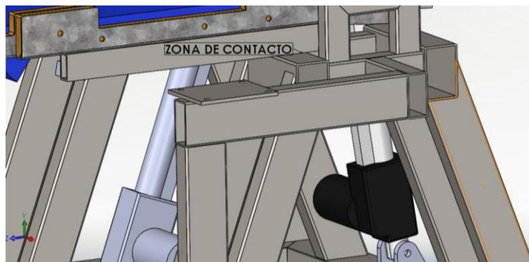
Figura 111. Zona de contacto chasis - marco estructural
