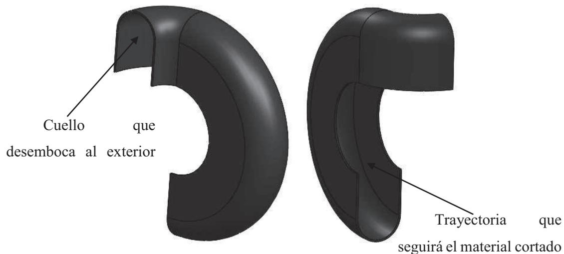
Figura 154. Posible geometría de la guarda de protección.
