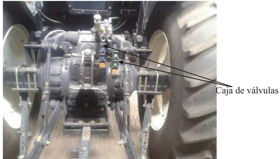
Figura 136. Válvulas remotas del sistema hidráulico de un tractor.
