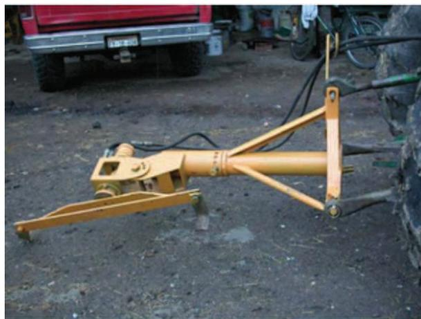
Figura 7. Cortadora de malezas para uso en regaderas, [Ledesma, 2005].
