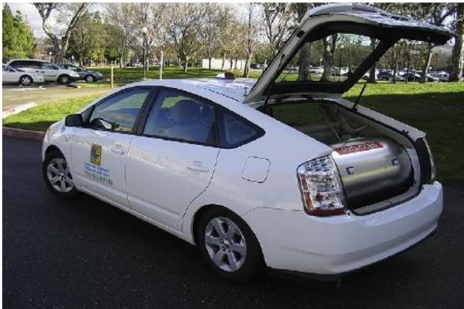
Figura 3. Recipiente de presión criogénico de hidrógeno montado en un automóvil para pruebas experimentales de manejo.
