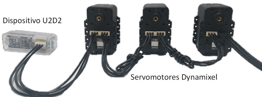
Figura 4.13: Conexión multipunto con servomotores
