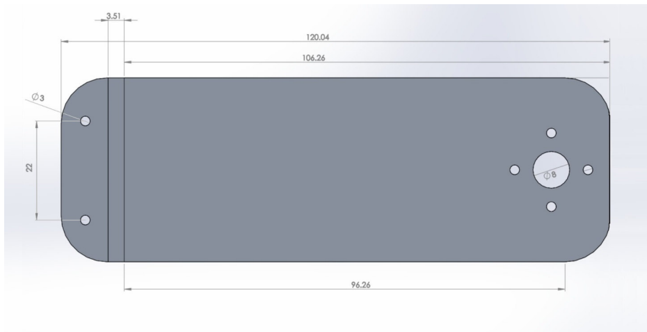
Figura 4.8: Vista frontal de pieza desdoblada para segundo eslabón
