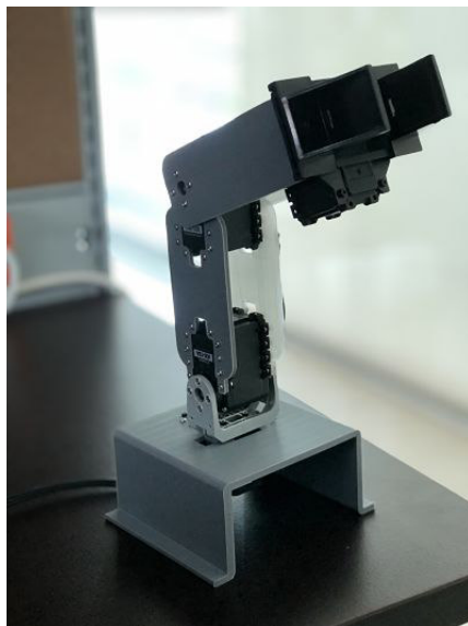
Figura 4.1: Brazo robótico construido
