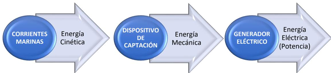
**Figura 2.3:** Esquema general de conversión de energía por corrientes marinas.
