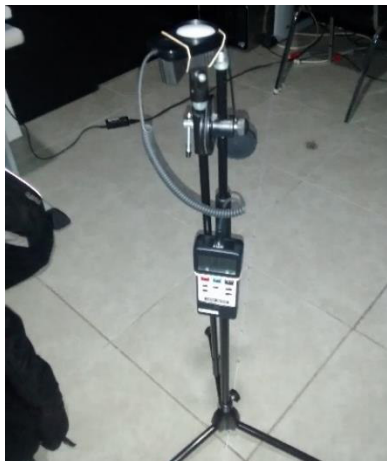
Figura 4.24. Fijación del luxómetro al pedestal tripie para realizar las pruebas de difusión de la luz.
