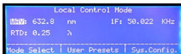
Figura Anexo I.4 Monitor del controlador del PEM-100 en modo de control local.
