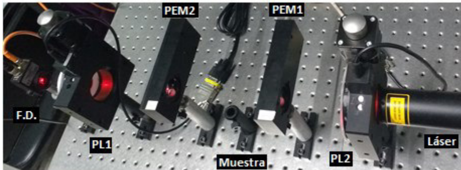
Figura 4.2 Arreglo físico del polarímetro dinámico de Stokes basado en transmisión.
