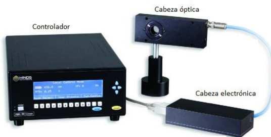
Figura 3.5 Partes que conforman el Pem-100 de la firma Hinds™ Instruments. 2
