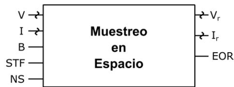
Fig.3.2.1. Módulo de mayor jerarquía dentro del diseño de la arquitectura digital.
