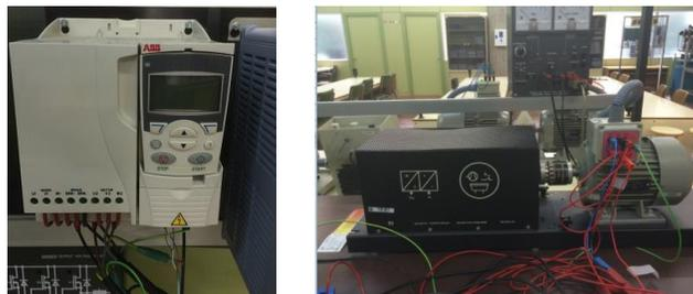
Fig.4.1.1. Banco de pruebas experimental: a) Inversor de voltaje, b) Motor de inducción de la marca Siemens sometido a carga mecánica mediante un freno electromagnético.
