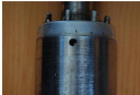
Fig. 4.2.1. Rotor con barra rota producida por una perforación de 2 mm de diámetro.
