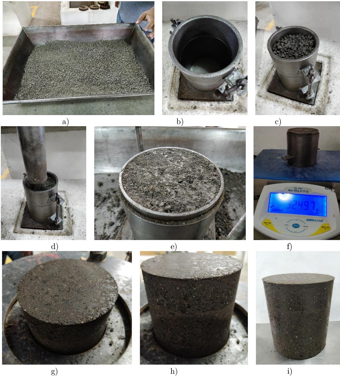
*Figura 4-10. Preparación de una probeta para el ensayo PROCTOR, a) disgregado del material, b) molde, c) escarificación de probeta, d) apisonamiento de la probeta, e) probeta enrasada, f) pesaje de la probeta con molde, g) separación de probeta y molde, h) separación de probeta, e i) probeta compactada.*
