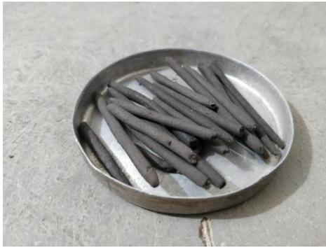
*Figura 4-8. Ensayo experimental para determinar el LP de la muestra de suelo.*
