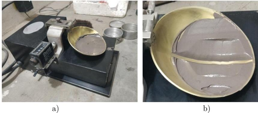
*Figura 4-7. Determinación de límite líquido, a) copa de Casagrande y b) muestra ranurada*
