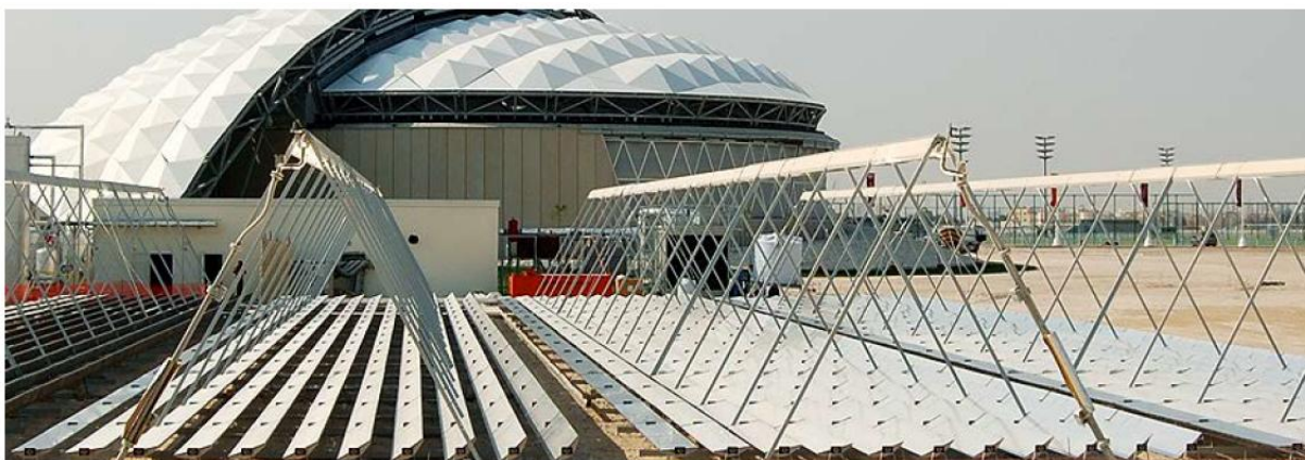
Figura 6. 6. Concentrador Fresnel de Industrial Solar.
