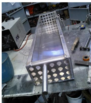
Figura 7. 7 Proceso de construcción del sistema PCM
