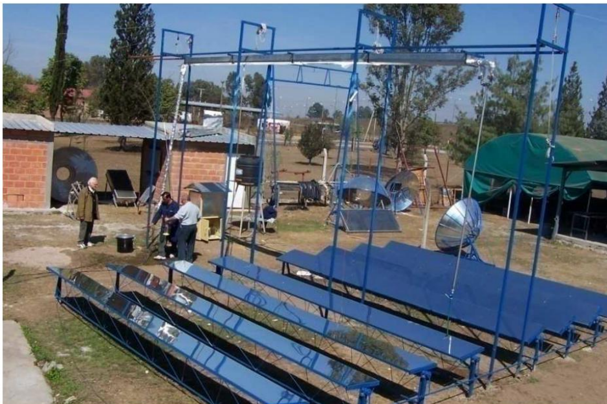
Figura 1. 15 Vista del Concentrador Fresnel con almacenamiento térmico [23]
