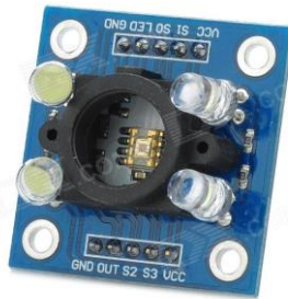
Figura 1. Sensor conversor de luz a frecuencia TCS3200
